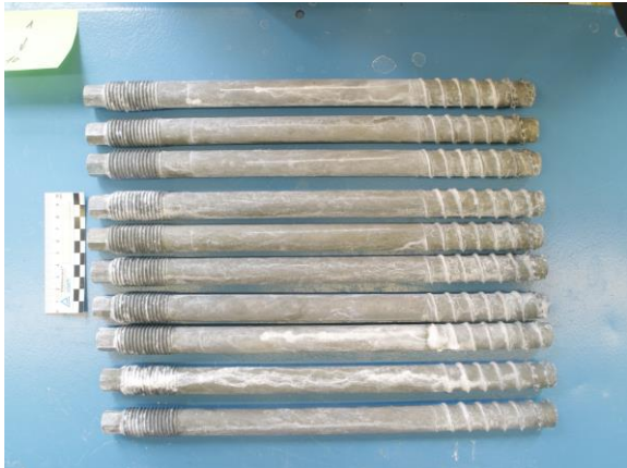
Bild 2 Prüfmuster 1-10 Nach 4800 Stunden Salzsprühnebelprüfung
