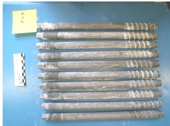
Bild 5 Prüfmuster 31-40 Nach 4800 Stunden Salzsprühnebelprüfung
