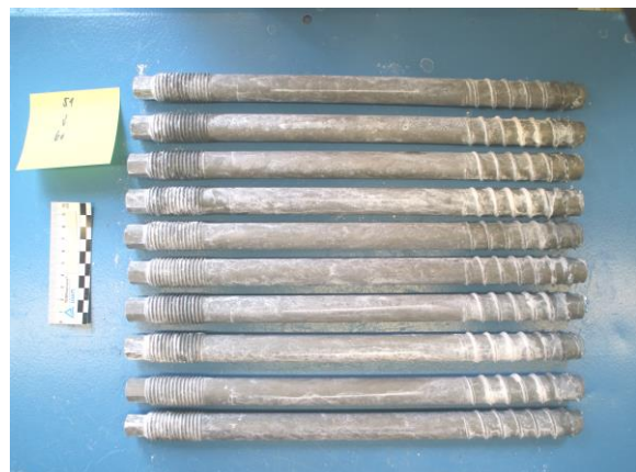
Bild 7 Prüfmuster 51-60 Nach 4800 Stunden Salzsprühnebelprüfung
