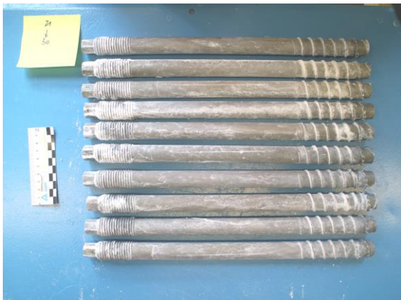
Bild 4 Prüfmuster 21-30 Nach 4800 Stunden Salzsprühnebelprüfung
