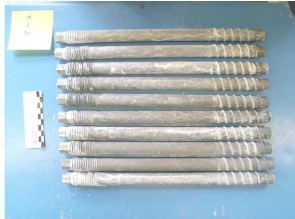
Bild 3 Prüfmuster 11-20 Nach 4800 Stunden Salzsprühnebelprüfung
