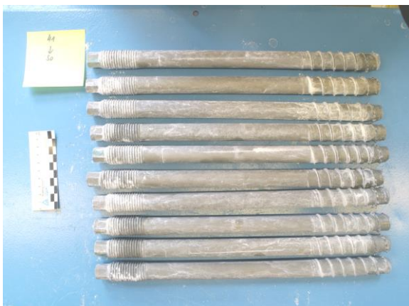
Bild 6 Prüfmuster 41-50 Nach 4800 Stunden Salzsprühnebelprüfung
