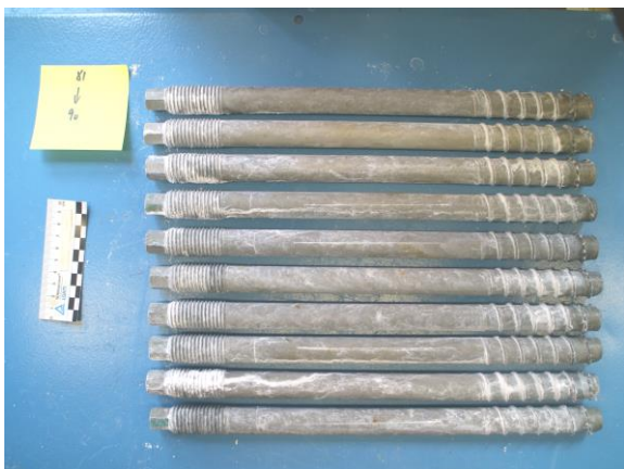
Bild 10 Prüfmuster 81-90 Nach 4800 Stunden Salzsprühnebelprüfung
