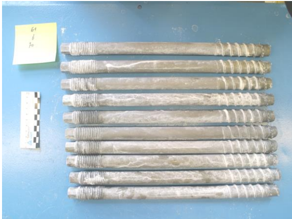
Bild 8 Prüfmuster 61-70 Nach 4800 Stunden Salzsprühnebelprüfung
