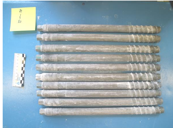
Bild 9 Prüfmuster 71-80 Nach 4800 Stunden Salzsprühnebelprüfung
